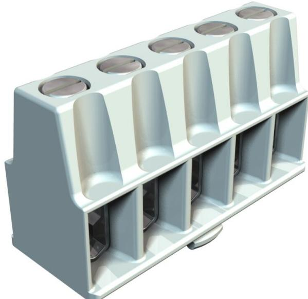
Bornes et vis en acier, galvanisées (passivation transparente), section nominale 1,5 ÷ 6 mm<sup>2</sup>, tension nominale 400 V, à 5 pôles, avec bornes à douilles, sections de raccordement maximales par point de raccordement: 3x6 mm<sup>2</sup>, 4x4mm<sup>2</sup> ou 6x2,5 mm<sup>2</sup>.
