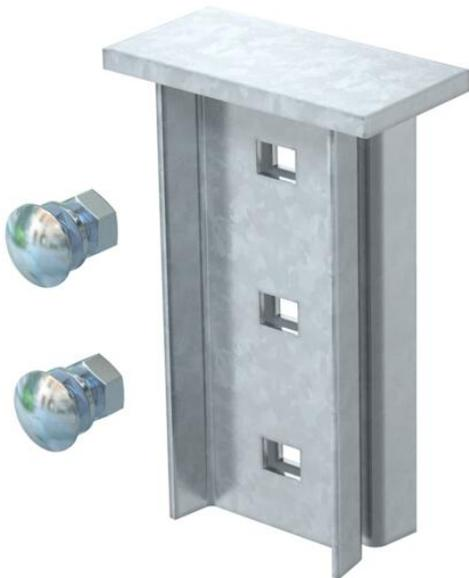
Plaque de tête à souder sur des structures de bâtiment. En association avec le montant IS 8, des pendants de toutes longueurs peuvent être réalisés sur site. La longueur du montant ne doit pas dépasser 2000 mm. Cette plaque de tête peut être montée sur les longueurs pré-coupées du montant IS 8. La plaque de tête est fixée au montant à l'aide de 2 vis tête bombée type FRS M10 x 25, à commander séparément.
