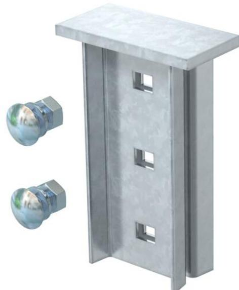
Kopfplatte zum Anschweißen an Gebäudekonstruktionen. In Kombination mit dem IS 8- Stiel können Hängestiele in allen Längen vor Ort hergestellt werden. Die Länge des Stiels darf max. 2000 mm betragen.
