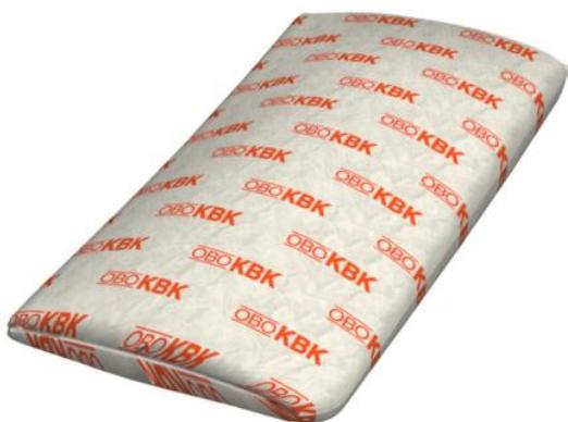
Cuscini antincendio per cavi in fibra di vetro a maglie fitte, a tenuta e meccanicamente resistenti con riempimento speciale. Senza fibre minerali, resistenti agli agenti atmosferici e insensibili all'acqua. Utilizzo in ambiente interno.
