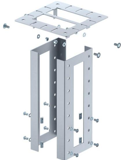
Sistema per il fissaggio a soffitto della colonna industriale ISS. Nella fornitura sono compresi 2 profili a U in lamiera d'acciaio da 3 mm, la piastra di fissaggio per il soffitto e gli accessori necessari al montaggio, incl. i blocchi scanalatura. Il fissaggio a soffitto è regolabile in altezza in modo variabile sul profilo della colonna.
