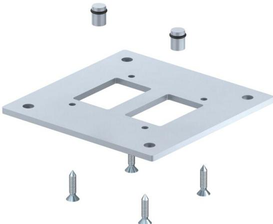
Piastra pavimento per il fissaggio della colonna industriale ISS a pavimento. Nella fornitura sono comprese 4 viti di fissaggio per il montaggio della piastra pavimento sul profilo della colonna e 2 tappi a tenuta per la chiusura a tenuta d'aria dei canali dell'aria compressa.
