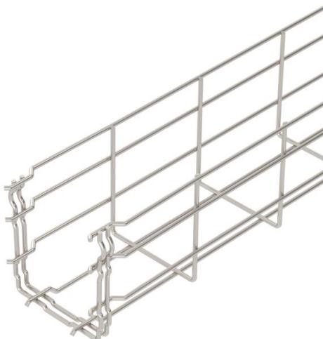
Passerella grigliata con giunto sagomato con bordo di altezza pari a 105 mm. Per la passerella grigliata non sono necessari ulteriori componenti di collegamento, le due estremità vengono semplicemente inserite una nell'altra. La dimensione delle maglie è di 50 x 100 mm. Schermatura elettromagnetica senza coperchio 15 dB, con coperchio 25 dB.
