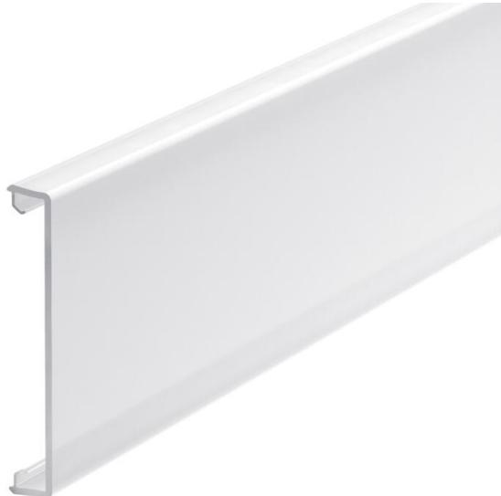
Kanaloberteil zum Verschließen der Geräteeinbaukanäle Rapid 80 GK (PVC), GS (Stahl), GA (Aluminium) und ISS Installationssäulen mit 76,5 mm Systemöffnung. Das Oberteil GK-OTGO ist aus einem lichtdurchlässigen, aber milchigen (Optik: geschliffenes Glas) PC-Material hergestellt und eignet sich somit zur Integration von Beleuchtung in den Kanälen bzw. Säulen.
