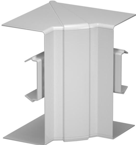
Coperchio per angolo interno in PC/ABS halogen free per la deviazione di direzione di canali per incasso apparecchi Rapid 80 dei sistemi GK, GKH, GS e GA. Regolabile in modo continuo da 85° a 95° e utilizzabili per canali simmetrici e asimmetrici.
