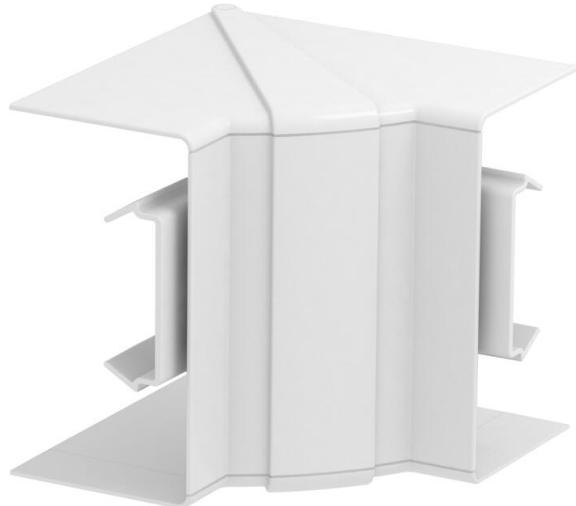
Inneneck-Haubenformteil aus halogenfreiem PC/ABS zur Richtungsänderung von Geräteeinbaukanälen Rapid 80 der Systeme GK, GKH, GS und GA. Die Formteile sind variabel von 85° - 95° verstellbar und einsetzbar für symmetrische und asymmetrische Kanäle.
