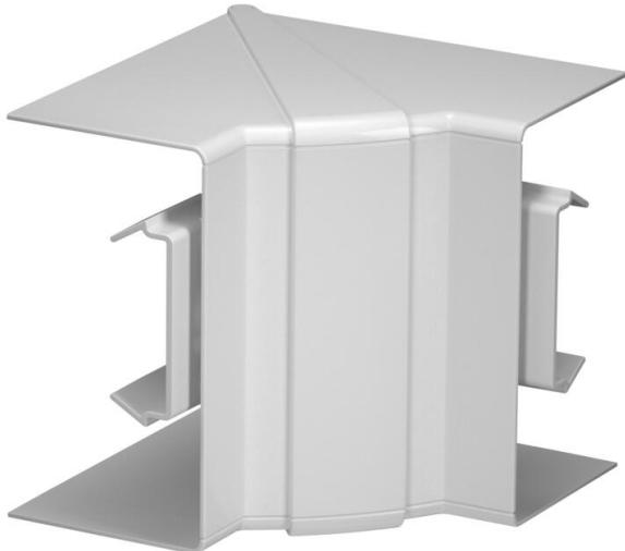
Coperchio per angolo interno in PC/ABS halogen free per la deviazione di direzione di canali per incasso apparecchi Rapid 80 dei sistemi GK, GKH, GS e GA. Regolabile in modo continuo da 85° a 95° e utilizzabili per canali simmetrici e asimmetrici.
