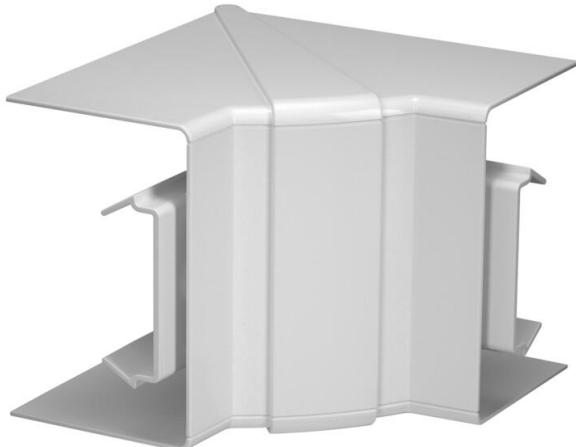
Coperchio per angolo interno in PC/ABS halogen free per la deviazione di direzione di canali per incasso apparecchi Rapid 80 dei sistemi GK, GKH, GS e GA. Regolabile in modo continuo da 85° a 95° e utilizzabili per canali simmetrici e asimmetrici.
