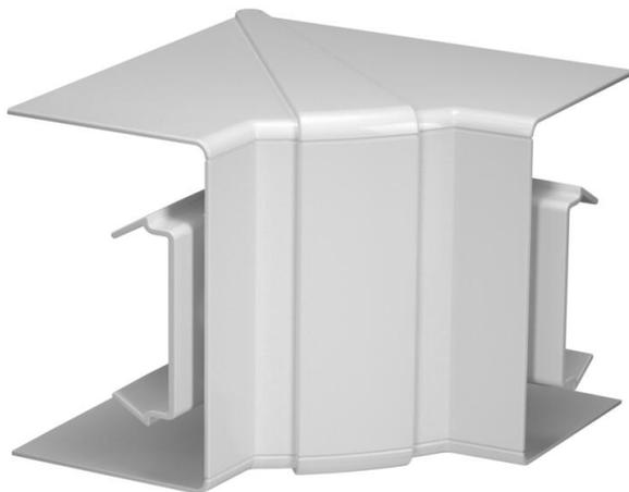
Inneneck-Haubenformteil aus halogenfreiem PC/ABS zur Richtungsänderung von Geräteeinbaukanälen Rapid 80 der Systeme GK, GKH, GS und GA. Die Formteile sind variabel von 85° - 95° verstellbar und einsetzbar für symmetrische und asymmetrische Kanäle.
