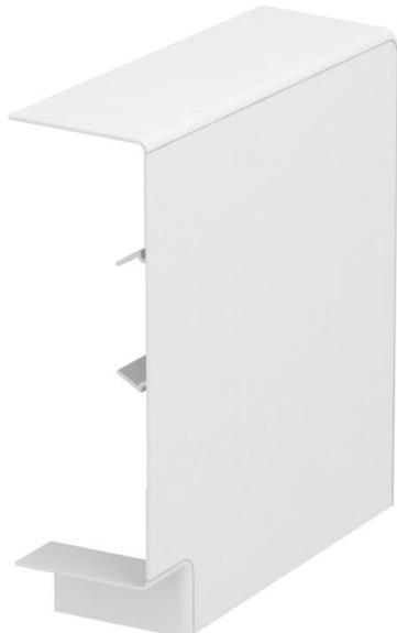
Calotta curva piana in PC/ABS privi di alogenri per una semplice realizzazione di una deviazione di direzione a 90° a salire o a scendere, con canale incasso apparecchi della serie Rapid 80 GK, GKH, GS e GA. Utilizzabile per tipi di canali simmetrici e asimmetrici.
