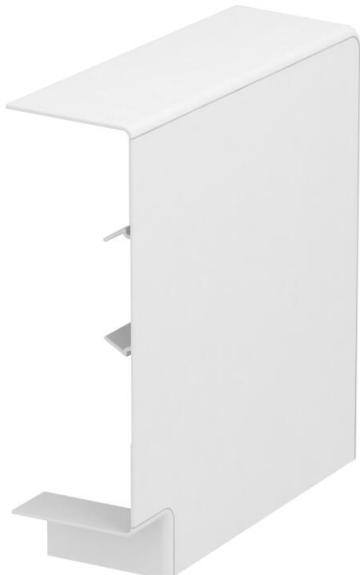
Flachwinkel-Haubenformteil aus halogenfreiem PC/ABS zur einfachen Erstellung einer steigenden oder fallenden 90° Richtungsänderung mit Geräteeinbaukanal der Serie Rapid 80 GK, GKH, GS und GA. Das Flachwinkel-Haubenformteil ist einsetzbar für symmetrische und asymmetrische Kanaltypen.
