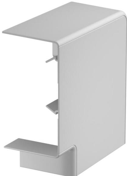
Calotta per angolare piatto in PC/ABS privo di alogenri per una semplice realizzazione di una deviazione di direzione a 90° a salire o a scendere, con canale incasso apparecchi della serie Rapid 80 GK, GKH, GS e GA. La calotta per l'angolare piatto è utilizzabile per tipi di canali simmetrici e asimmetrici. Il coperchio deve essere ordinato separatamente.
