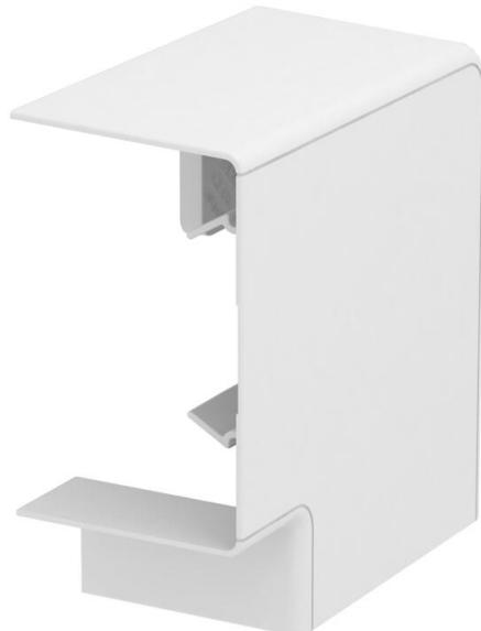
Flachwinkel-Haubenformteil aus halogenfreiem PC/ABS zur einfachen Erstellung einer steigenden oder fallenden 90° Richtungsänderung mit Geräteeinbaukanal der Serie Rapid 80 GK, GKH, GS und GA. Das Flachwinkel-Haubenformteil ist einsetzbar für symmetrische und asymmetrische Kanaltypen.
