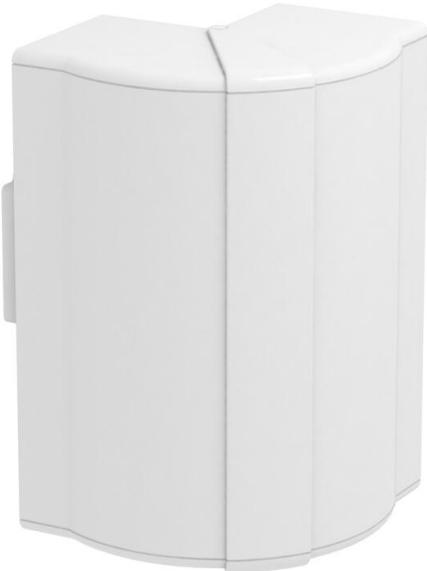
Angle extérieur variable en PC/ABS sans halogène pour changement de direction des canaux d'allège Rapid 80 des systèmes GK, GKH, GS et GA. Les pièces de forme sont réglables de 80° à 100° et elles sont utilisables pour des goulettes symétriques et asymétriques.
