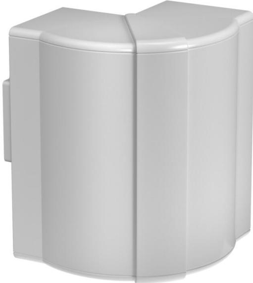
Angle extérieur variable en PC/ABS sans halogène pour changement de direction des goulettes d'appareillage Rapid 80 des systèmes GK, GKH, GS et GA. Les pièces de forme sont réglables de 80° à 100° et elles sont utilisables pour des goulettes symétriques et asymétriques.
