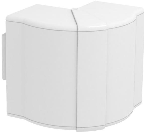
Coperchio per angolo esterno in PC/ABS per la deviazione di direzione di canali per incasso apparecchi Rapid 80 dei sistemi GK, GS e GA. Regolabile in modo continuo da 80° a 100° e utilizzabili per canali simmetrici e asimmetrici. L'elemento superiore deve essere ordinato separatamente.
