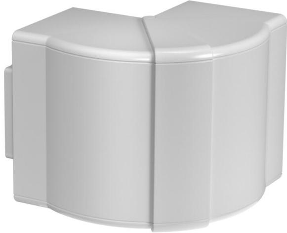
Coperchio per angolo esterno in PC/ABS per la deviazione di direzione di canali per incasso apparecchi Rapid 80 dei sistemi GK, GS e GA. Regolabile in modo continuo da 80° a 100° e utilizzabili per canali simmetrici e asimmetrici.
