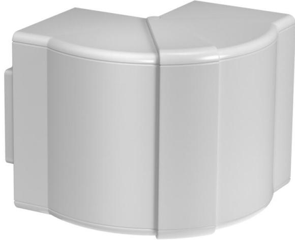
Angle extérieur variable en PC/ABS sans halogène pour changement de direction des goulettes d'appareillage Rapid 80 des systèmes GK, GKH, GS et GA. Les pièces de forme sont réglables de 80° à 100° et elles sont utilisables pour des goulettes symétriques et asymétriques.
