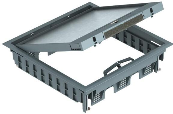
Boîtier de sol avec poignée étrier pour 12 appareillages individuels Modul 45 maximum sur 3 supports universels UT4, insertion dans les systèmes de goulottes et dans les faux planchers en intérieur.
