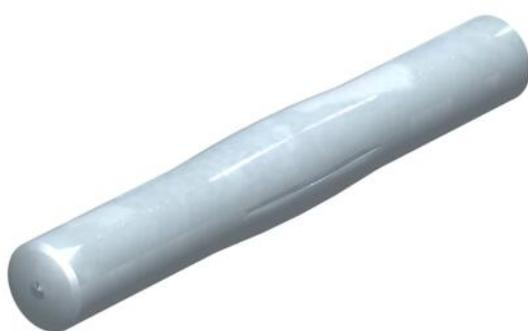
Stoßstellenverbinder als Kerbstift zum direkten Stoß auf Stoß-Verbinden der Kanalunterteile ohne Stoßstellenabdeckung. Passend für Geräteeinbaukanäle Aluminium der Serie Rapid 80 sowie Rapid 45-2 und GAD Designkanal bei Verwendung der Systeme zur Leitungsführung bzw. mit Modul45-connect. Ebenfalls kompatibel mit dem Bodenkanal BK 1874.
