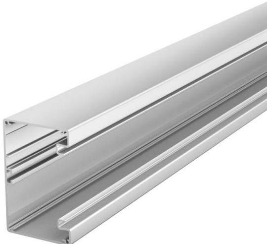
Canale di incasso apparecchi senza foratura alla base indicato per il montaggio diretto a parete o su mensole. Su richiesta possono essere realizzati anche elementi inferiori e superiori del canale con lunghezze extra, fino a 6000 mm, e anche altri colori RAL. Le superfici visibili dei canali di incasso apparecchi sono laminate.
