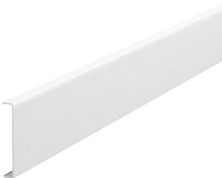
Couvercle en aluminium pour la fermeture des canaux d'allège GA Rapid et des colonnes d'installation ISS avec une ouverture du système de 76,5 mm. La mise en place ferme du couvercle et les contacts électriques du socle de la goulotte/ colonne est garantie par des pinces de fixation de type RKV3V. 6 pinces de fixation sont prémontées dans chaque longueur disponible (2000 mm).
