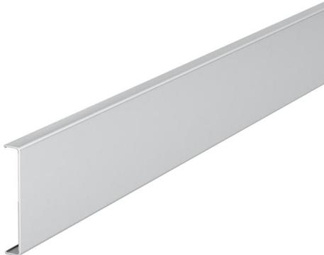
Parte superiore per la chiusura di canali per incasso apparecchi Rapid 80 GK (PVC), GS (acciaio), GA (alluminio) e colonne ISS con apertura sistema da 76,5 mm. Il contatto elettrico tra la parte superiore e quella inferiore del canale/della colonna è garantito da morsetti ad incastro del tipo RKV3V. Per ogni lunghezza di fornitura (2000 mm) sono montati di serie 6 morsetti a incastro.
