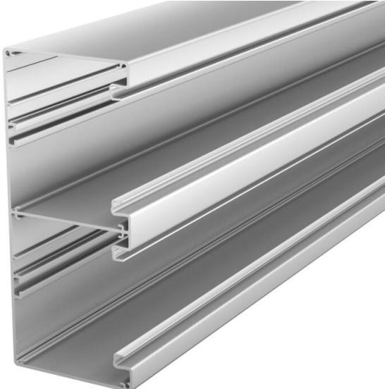
Canal d'allège fond non perforé pour le montage direct au mur ou sur des consoles. Des longueurs spéciales jusqu'à 6000 mm de couvercles et de socles de goulotte ainsi que d'autres couleurs RAL peuvent être réalisées sur demande. Les surfaces visibles des goulettes d'appareillages sont recouvertes d'un film de protection.
