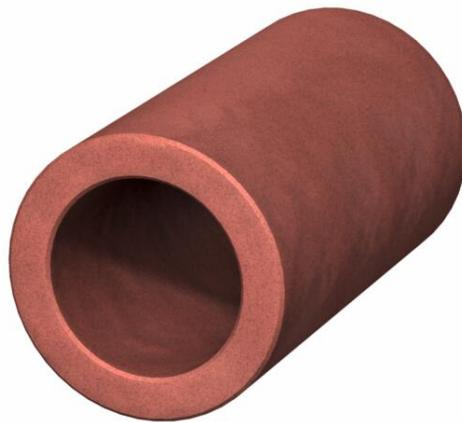
Leere Rohrhülse für den Einsatz im Kleinschott FBA-SP in leichten Trennwänden. Anwendung im Innenbereich. Rohrhülse vor Wasser schützen, um ein sicheres Aufschäumen im Brandfall zu garantieren.
