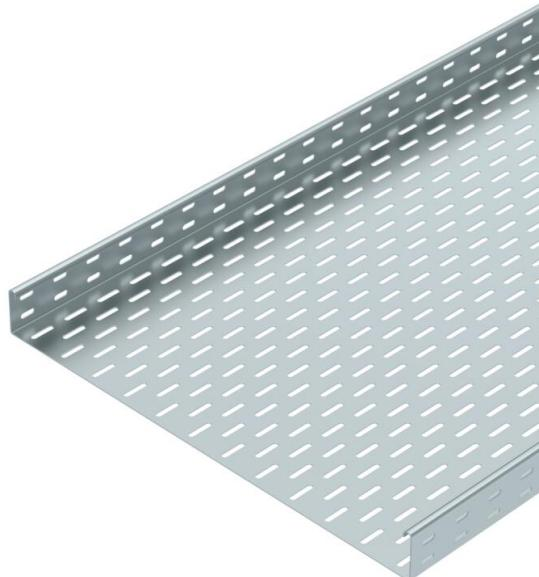
EKS 60 = système de chemins de câbles extra-lourd, hauteur latérale de 60 mm. Les raccords droits doivent être commandés pour tous les modèles séparément en quantité nécessaire. Atténuation magnétique du blindage sans couvercle 20 dB, avec couvercle 50 dB.
