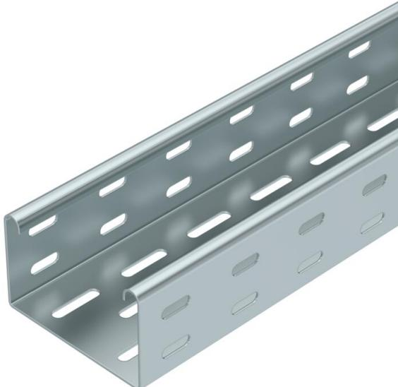
EKS 60 = système de chemins de câbles extra-lourd, hauteur latérale de 60 mm. Les raccords droits doivent être commandés pour tous les modèles séparément en quantité nécessaire. Atténuation magnétique du blindage sans couvercle 20 dB, avec couvercle 50 dB.
