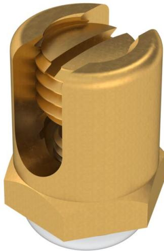
Morsetto di messa a terra per il fissaggio del conduttore equipotenziale su passerella portacavi. Perno filettato M12 con intaglio. Idoneo per sezioni di cavo 4-50 mm<sup>2</sup>. Con rondella dentata a ventaglio e vite a testa tonda.
