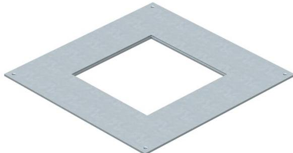
Coperchio di montaggio per scatole di derivazione da incasso del tipo UZD250-3/4 per l'installazione di un'unità di montaggio di dimensione nominale 4. Apertura di montaggio profonda 3 mm per la successiva chiusura con coperchio cieco.
