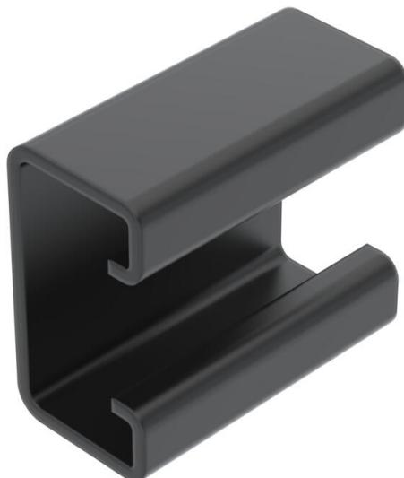
Entretoise pour stabiliser les profilés US 3, empêche la déformation du montant ou du pendar lors du montage de la console avec vis à tête hexagonale traversante. Le matériel de fixation doit être commandé séparément. Revêtement par poudrage en noir profond (RAL 9005).
