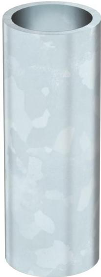
I manicotti di distanziamento per il montaggio di staffe sospese sotto soffitti isolati impediscono lo schiacciamento dell'isolamento durante il serraggio delle viti di fissaggio.
