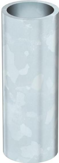
Les douilles d'écartement pour le montage d'étriers de suspension sous des plafonds coupe-feu évitent l'enfoncement de l'isolation lors du serrage des vis de fixation.
