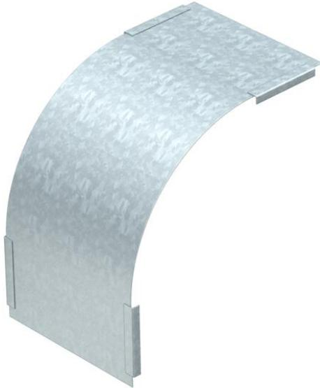
Couvercle pour coudes verticaux convexes d'une hauteur d'aile de 85. La fixation est assurée par le chevauchement du couvercle de chemin de câbles. Pour plus de solidité, le couvercle peut être fixé avec des clips de fixation pour couvercle.
