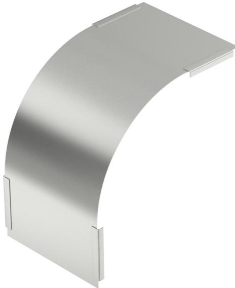
Coperchio per le curve verticali in discesa con altezza del bordo 60. Il fissaggio viene assicurato tramite l'installazione dei coperchi della passerella portacavi. Inoltre il coperchio può essere fissato con clip per coperchio.
