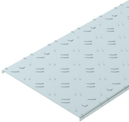
Riffelblechdeckel für das begehbar Kabelrinnen-System Typ BKR. Die Deckelstärke setzt sich aus 2,0 mm doppelt bandverzinktem Stahlblech und 1,3 mm Riffelhöhe zusammen. Vorgeprägte Ausbrechöffnungen im Abstand von 100 mm ermöglichen eine nachträgliche Installation eines Drehriegels. Bei Verwendung von Deckeln im Außenbereich sind zusätzliche Maßnahmen gegen Windeinflüsse vorzunehmen.
