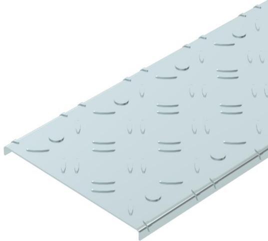
Riffelblechdeckel für das begehbar Kabelrinnen-System Typ BKR. Die Deckelstärke setzt sich aus 2,0 mm doppelt bandverzinktem Stahlblech und 1,3 mm Riffelhöhe zusammen. Vorgeprägte Ausbrechöffnungen im Abstand von 100 mm ermöglichen eine nachträgliche Installation eines Drehriegels. Bei Verwendung von Deckeln im Außenbereich sind zusätzliche Maßnahmen gegen Windeinflüsse vorzunehmen.
