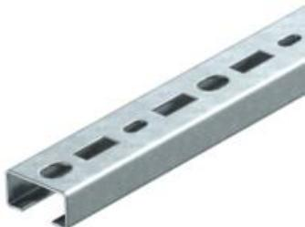
Profilato C centrale per la posa dei cavi, in unione con la staffa reggicavo con base a testa di martello. Utilizzabile anche come costruzione di sospensione per sistemi di canalizzazioni portacavi.
