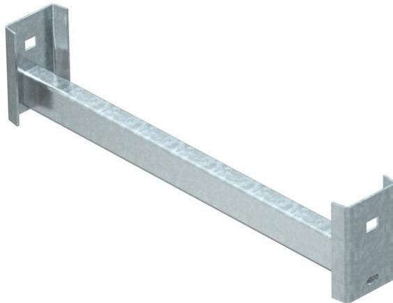
Profilo CK40 per l'impiego in passerelle a spalliera pesanti e nel profilato IS 8. Carico massimo per profilo e 175 kg.
