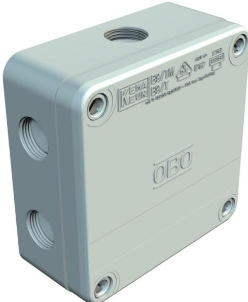
Der Kabelabzweigkasten B9/T... besteht aus zwei verschiedenen halogenfreien Kunststoffkomponenten. Er hat 8 Gewindestiefeinführungen mit Durchstoßmembranen (7 x M20 seitlich und 1 x PG16 im Boden) sowie eine Membraneinführung im Boden für Kabeldurchmesser bis 15 mm. Bei Verwendung der Kabelverschraubungen (zusätzliche Zugentlastung) ist ein Entfernen der Membran nicht erforderlich (Zeitgewinn). Schutzart IP 67 bei Durchstoßmembrane und bei Kabelverschraubung ohne Entfernen der Durchstoßmembrane.
