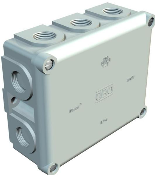
Schutzart IP54, Nennspannung 660 V, Nennquerschnitt 10  $\div$  mm $^2$ , 2 Befestigungslöcher für Schrauben bis 6 mm Ø an der Außenseite des Kastens, 4 Deckelschrauben, 10 ausbrechbare Einführungen mit Gewinde M20 x 1,5, vorzugsweise für Kabelverschraubungen mit kurzem Anschlussgewinde.
