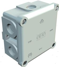
Schutzart IP54, Nennspannung 660 V, Nennquerschnitt 2,5 ÷ 4, in Kombination mit dem Klemmstein 700/6 M hat der Kasten den Nennquerschnitt 4 mm<sup>2</sup>, 2 Befestigungslöcher für Schrauben bis 5 mm Ø an der Außenseite des Kastens. 4 Deckelschrauben, 7 ausbrechbare Einführungen mit Gewinde M20 x 1,5, vorzugsweise für Kabelverschraubungen mit kurzem Anschlussgewinde.
