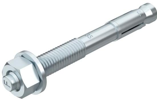
Bolzenanker BZ zur Verankerung mittelschwerer bis schwerer Lasten, sowohl im gerissenen als auch ungerissenen Beton. Er vereint hohe zulässige Lasten mit geringen Rand- und Achsenabständen.
