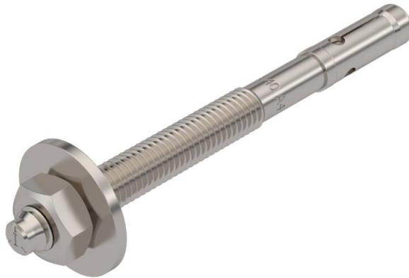
Bolzenanker BZ3 zur Verankerung mittelschwerer bis schwerer Lasten in gerissem oder ungerissenem Beton. Geeignet für hohe Lasten mit geringen Rand- und Achsenabständen. Zum Einschlagen.
