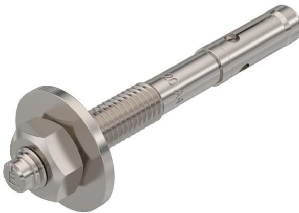
Bolzenanker BZ3 zur Verankerung mittelschwerer bis schwerer Lasten in gerissem oder ungerissenem Beton. Geeignet für hohe Lasten mit geringen Rand- und Achsenabständen. Zum Einschlagen.
