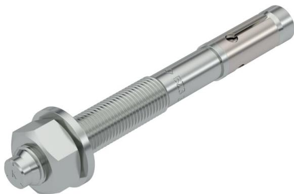
Cheville d'ancrage à expansion BZ3 pour ancrage de charges semi-lourdes et lourdes dans du béton fissuré ou non fissuré. Il associe des charges admissibles élevées à de faibles entraxes et écartements entre les bords.
