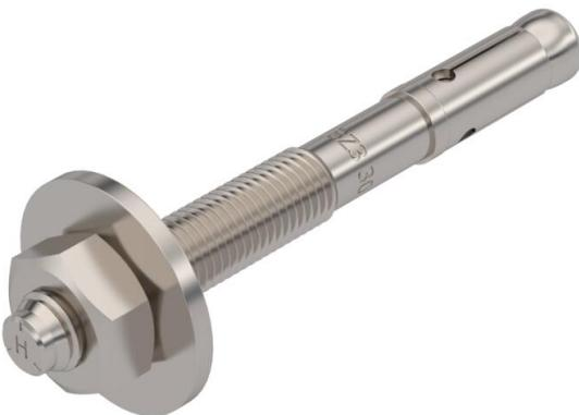
Cheville d'ancrage à expansion BZ3 pour ancrage de charges semi-lourdes et lourdes dans du béton fissuré ou non fissuré. Il associe des charges admissibles élevées à de faibles entraxes et écartements entre les bords.
